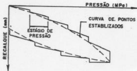
Resultado de uma prova de carga
