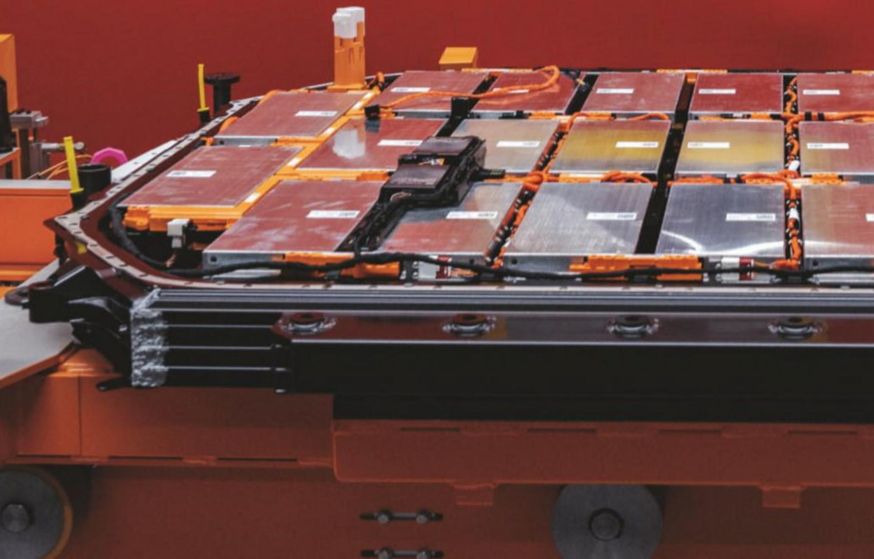
Numa fábrica de Bruxelas, na Bélgica, um operário examina a bateria de iões de lítio que fornecerá energia ao Audi e-tron, um carro eléctrico. A bateria arrefecida através de um líquido especial para o efeito é composta por módulos separados, integrados no piso do automóvel. As vendas crescentes de veículos eléctricos desencadearam um aumento significativo na extracção de lítio.
