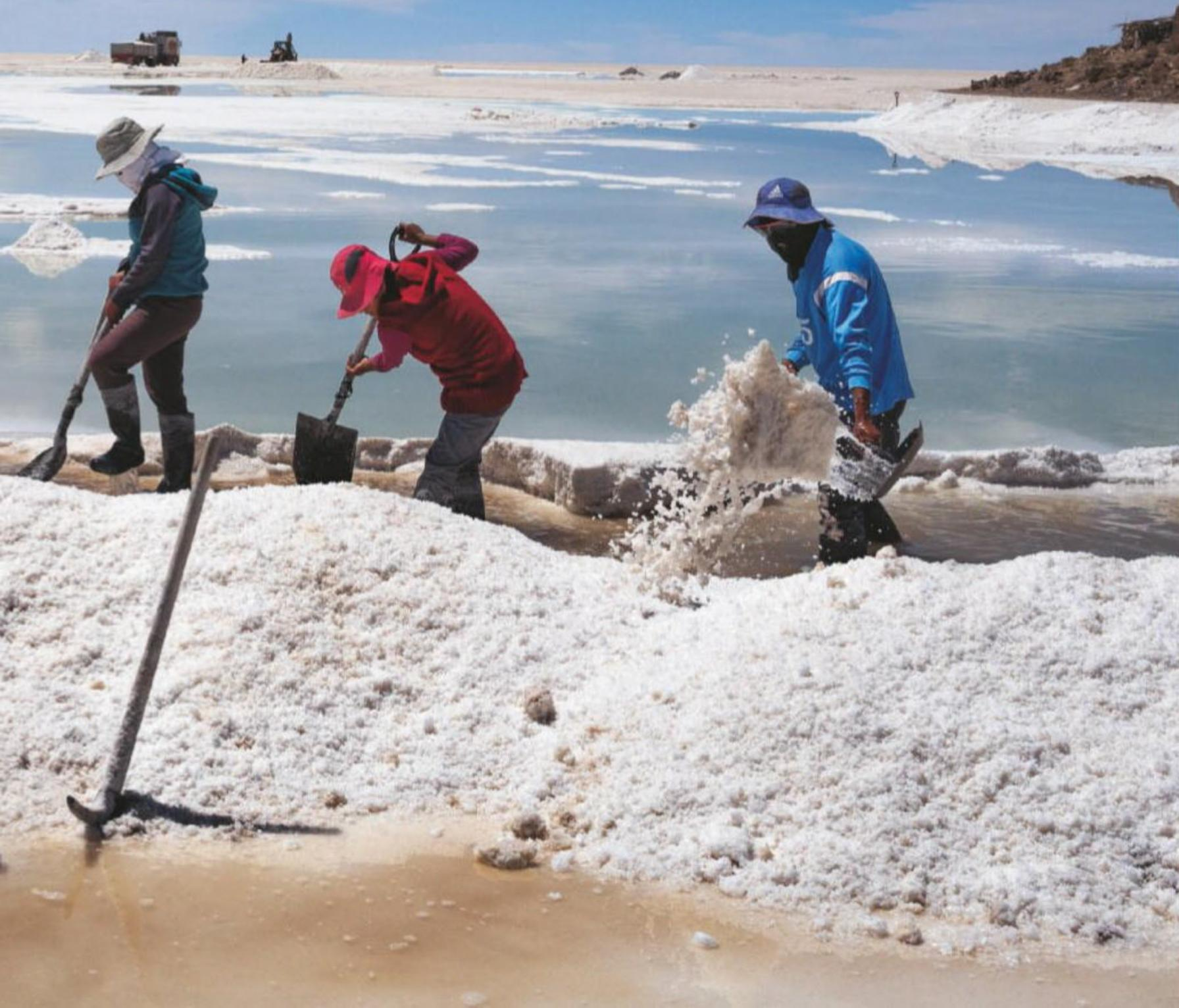
Lagoas de evaporação escavadas no salar de Uyuni criam um mosaico colorido na fábrica-piloto de Llipi. A fábrica começou a produzir carbonato de lítio em 2013. A salmoura rica em lítio é bombeada para as lagoas à superfície a partir de profundidades máximas de 20 metros. Um dia, a fábrica terá duzentas destas lagoas.
