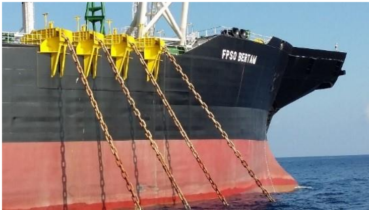
FPSO Bertam Detalhe do fairlead
