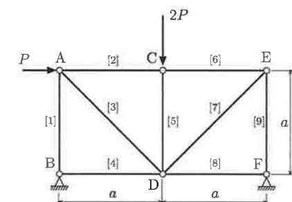
20. Para as barras da treliça ao lado, calcule as forças normais decorrentes da eliminação da folga  $\Delta$  na fixação da extremidade da barra 6 com o nó E. Admita  $EA = \text{const.}$
