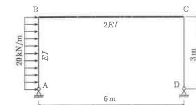
29. Trace os diagramas de esforços solicitantes para o pórtico plano da figura sujeito ao carregamento indicado. Considere apenas o efeito da deformação por momento fletor e  $EI = \text{const.}$  para todas as barras.
