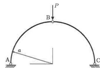
16. Para o carregamento indicado, determine o deslocamento vertical e a rotação da seção transversal do nó C da estrutura ao lado. Considere o efeito das deformações por força normal e momento fletor, com  $EI = \text{const.}$  e  $EA = \text{const.}$
