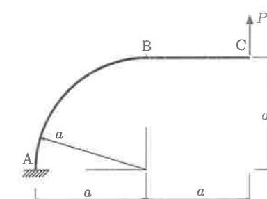
15. Calcule o deslocamento vertical do ponto de aplicação da carga  $P$  para o arco semicircular tri-articulado de raio  $a$ . São conhecidos o módulo de elasticidade  $E$  e o momento de inércia à flexão  $I$  da seção transversal.
