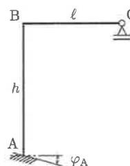
26. Trace o diagrama de momentos fletores e calcule o deslocamento vertical do ponto de aplicação da carga  $P$ . São conhecidos o módulo de elasticidade  $E$  e o momento de inércia à flexão  $I$  da seção transversal.
