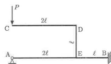
27. Na estrutura ao lado, a barra AB é vertical e as barras BC e CD estão em um plano horizontal, o ponto D preso a uma mola vertical de rigidez  $k$ . Para o carregamento indicado, trace os diagramas de momento fletor e momento de torção, e calcule o deslocamento vertical do ponto D e a rotação  $\varphi_{Cy}$  em torno do eixo  $y$ . São dados:  $EI = 10^4 \text{ kN m}^2$ ,  $GI_T = 5 \times 10^3 \text{ kN m}^2$ ,  $k = 10^4 \text{ kN/m}$ .
