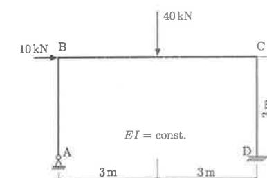
30. Determine os diagramas de esforços solicitantes quando a estrutura ao lado é submetida a uma variação de temperatura  $\Delta T$  no seu lado externo. Adote  $h = a/2$  e considere a deformação axial produzida pela temperatura, mas despreze os efeitos das deformações por força normal e força cortante ( $EA = GA = \infty$ ).
