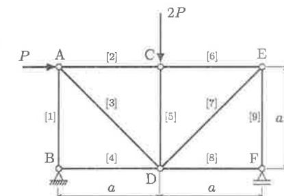
12. Para a estrutura ao lado, calcule o deslocamento horizontal do ponto C e a rotação do ponto A. Considere apenas a deformação por flexão com  $EI = \text{const.}$
