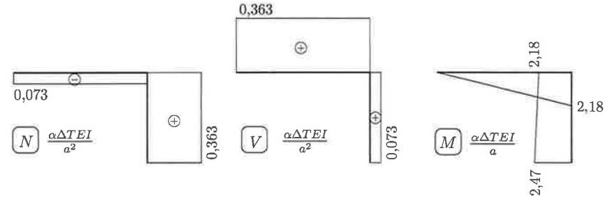
Determine os diagramas de esforços solicitantes quando a estrutura ao lado é submetida a uma variação de temperatura  $\Delta T$  no seu lado externo. Considere a deformação axial produzida pela temperatura mas despreze os efeitos das deformações por força normal e força cortante ( $EA = GA = \infty$ ).
