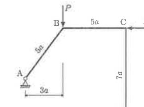
13. Determine os deslocamentos  $v_F$  e  $u_B$  do pórtico tri-articulado desprezando as deformações por força normal e força cortante. São dados:  $E = 2000 \text{ kN/cm}^2$  e as dimensões da seção transversal retangular,  $b = 20 \text{ cm}$  e  $h = 45 \text{ cm}$ .
