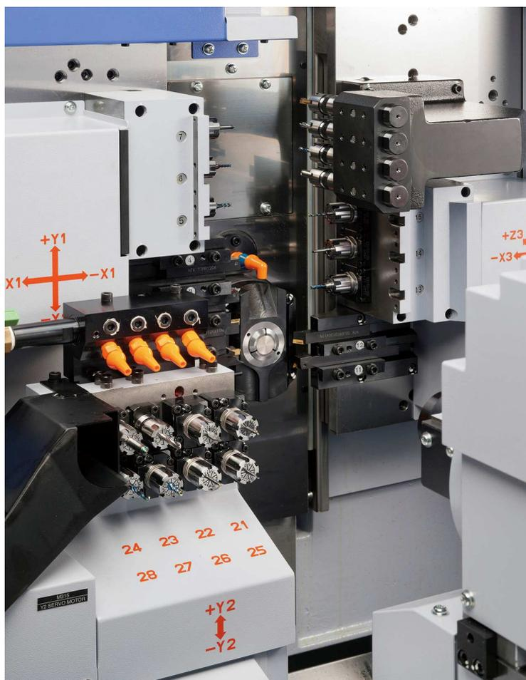
Figura 3 - Área de trabalho de um Centro de Torneamento de Cabeçote Móvel, marca Star, modelo SW-20
