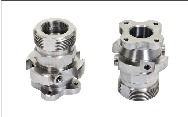
Figura 4 – Peças usinadas por completo em um Centro de Torneamento de Carros Múltiplos, marca Ergomat, modelo TBS<sup>y</sup>
