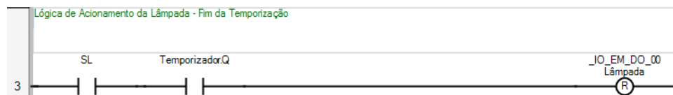
Figura 12 – Lógica de acionamento da lâmpada.
