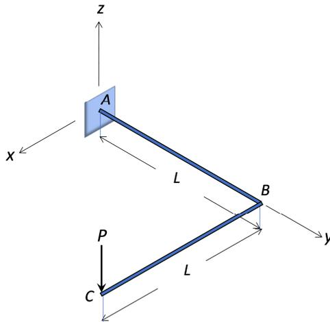
A estrutura  $ABC$  da figura está contida em um plano horizontal. Ela é formada por uma barra de seção circular cheia, de raio  $R$ , dobrada em ângulo de  $90^\circ$ , e engastada no ponto  $A$ . A estrutura está submetida apenas à força vertical  $P$  aplicada ao ponto  $C$ . É dada a rigidez flexional da viga  $EI$ . Pedem-se:
