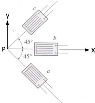
A roseta da figura está colada a um ponto P da superfície de um corpo submetido a um certo carregamento. As leituras dos seus extensômetros são  $\varepsilon_a = 150\mu$ ,  $\varepsilon_b = 100\mu$  e  $\varepsilon_c = 150\mu$ . Sabendo que o corpo é feito de um material dúctil, pede-se determinar qual é o fator de segurança no ponto em que está colada a roseta, para o carregamento aplicado.
