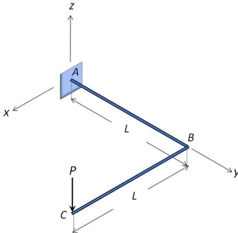
A viga ABC da figura está contida em um plano horizontal. Ela é formada por um arame com seção circular de raio  $R$ , dobrado em ângulo de  $90^\circ$ , e está engastada no ponto A. A viga está submetida apenas à força vertical  $P$  aplicada ao ponto C. Pede-se determinar a matriz  $[E]$  que representa o tensor das pequenas deformações no ponto de coordenadas  $(0, L/2, R)$  orientada pelo sistema de eixos indicado.
