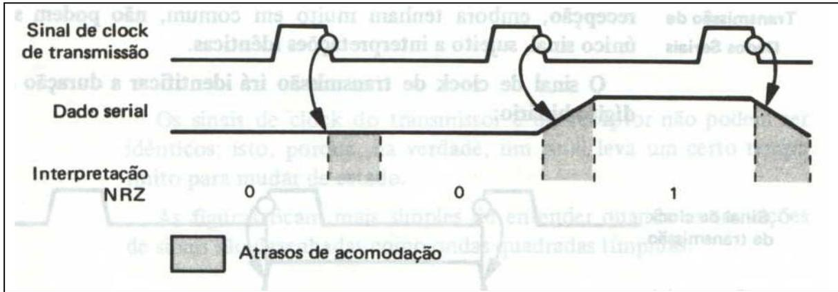
Podemos usar um único sinal de clock para transmitir e receber dados seriais, desde que se transmita na transição negativa do pulso de clock e se receba na transição positiva do próximo pulso de clock:
