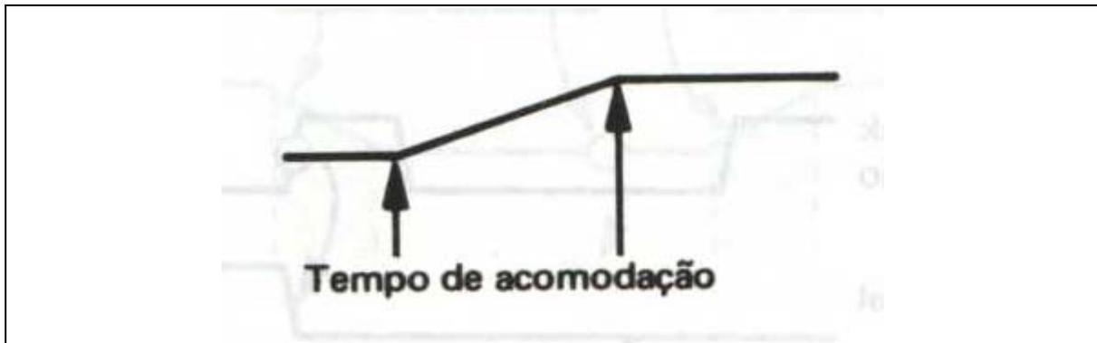
Se utilizarmos a mesma transição de *clock* para transmitir e receber dados seriais, então o tempo de acomodação do sinal fará com que a amostragem do sinal recebido se dê antes que a transição de nível do sinal transmitido tenha tido tempo para ocorrer. Isto pode ser ilustrado da seguinte maneira:
