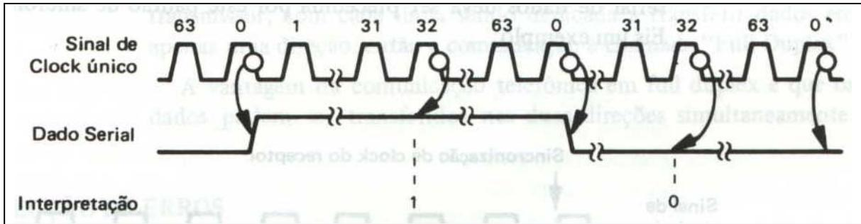
A razão para termos clock X 16 e X 64 é para se chegar o mais rápido possível do centro do intervalo de tempo de duração de um único dígito ao amostrarmos um sinal de dado serial.
