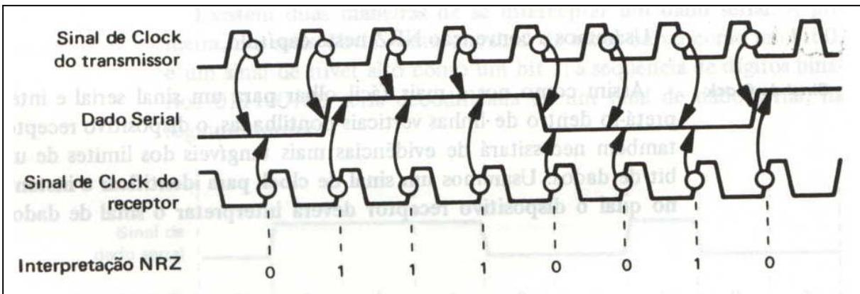
Os sinais de clock do transmissor e do receptor não podem ser idênticos; isto, porque, na verdade, um sinal leva um certo tempo finito para mudar de estado. As figuras ficam mais simples de entender quando as transições de sinais são desenhadas como ondas quadradas límpidas:
