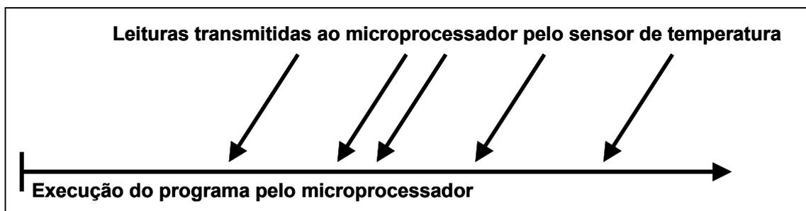
Devido as transmissões de dados do sensor para o sistema serem imprevisíveis (ou assíncronas), o programa GRAVA deverá ser executado cada vez que o sensor de temperatura transmite um item de dados. O programa GRAVA contém uma seqüência de instruções que move dados de uma porta de E/S para um byte de memória RAM; esta seqüência de instruções não pode fazer parte do programa AJUSTA, desde que a lógica deste programa não consegue detectar a chegada de um dado do sensor de temperatura.
