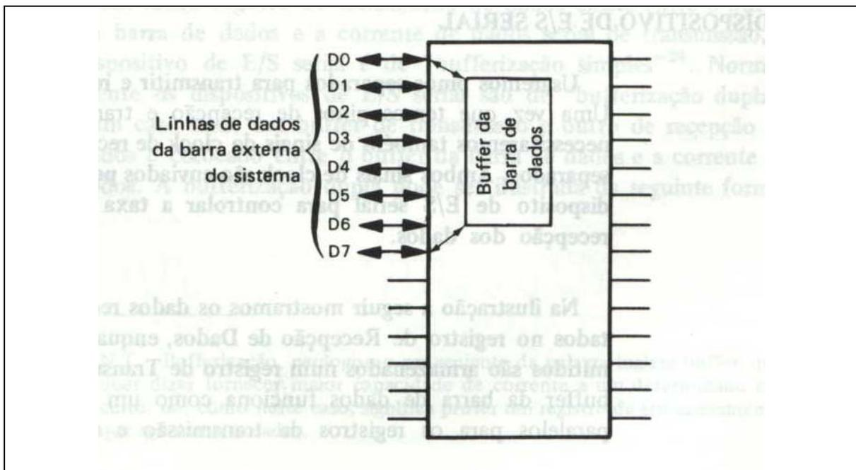
Os outros sinais requeridos pela interface do microprocessador não são diferentes daqueles incluídos no dispositivo de E/S paralela. Usaremos o Select e o IORW. O *Select* é decodificado da barra de endereços para selecionar o dispositivo de E/S serial; IORW seleciona tanto uma “leitura para” o microprocessador quanto uma “escrita do”
