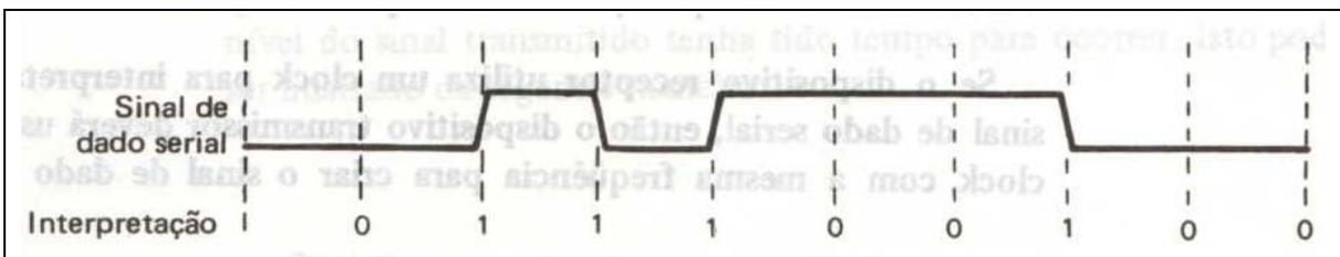
Como ilustrado, a transição negativa do sinal de clock identifica o instante em que o sinal de dados serial deverá ser amostrado. Poderíamos também facilmente amostrar na transição positiva do sinal de clock.
