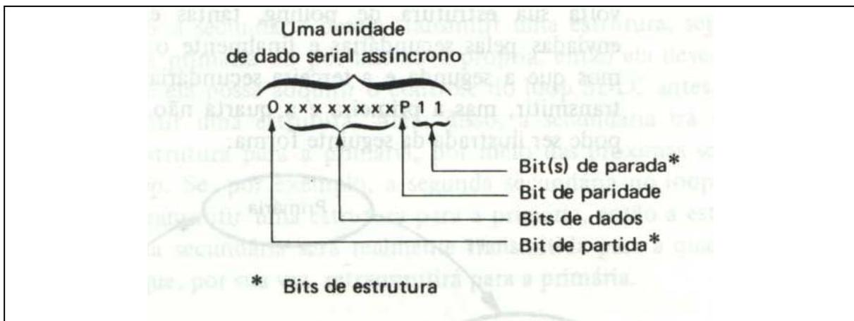
Ter um único bit de partida 0 é universalmente aceito no mundo dos microcomputadores. Existe uma semelhança entre os caracteres SYNC da corrente de dados síncrona, e os bits de estrutura de uma corrente de dados assíncrona.
