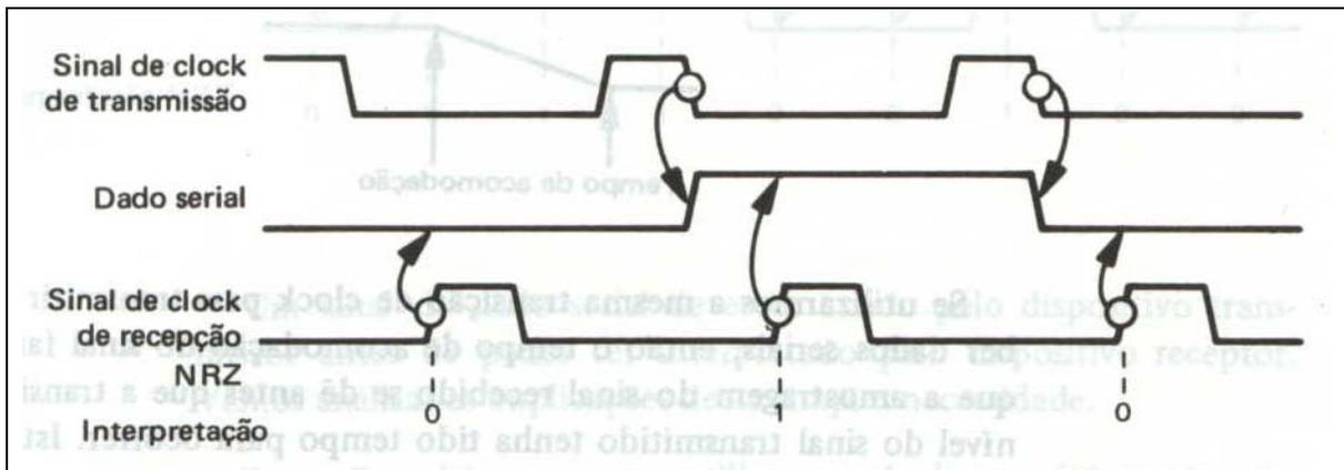
A ilustração mostra o sinal de *clock* de transmissão ativo na borda de descida, enquanto que o sinal de *clock* de recepção está ativo na sua borda de subida; não há nada de significativo na escolha destas bordas dos sinais.
