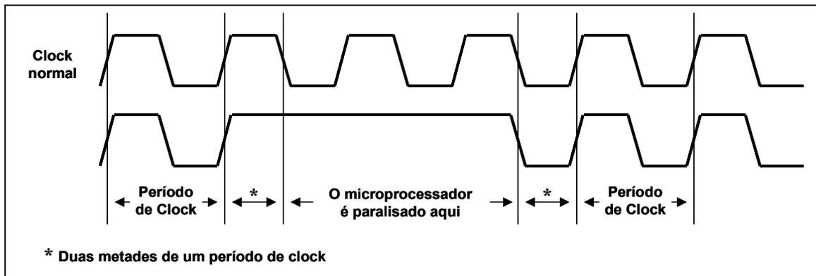
O microprocessador pode ter uma entrada de controle que o faz colocar flutuando todas as conexões de pinos para barra externa do sistema, enquanto suspende as operações internas. Isto pode ser ilustrado assim:
