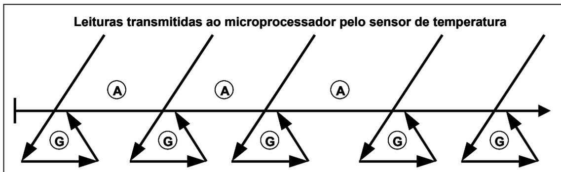
Cada vez que o sensor de temperatura estiver pronto para transmitir dados para o sistema, ele notifica ao microprocessador pedindo uma interrupção. Em resposta a este pedido, a lógica de programa suspende a execução do programa AJUSTA [ A ] e passa a executar o programa GRAVA [ G ]. O programa GRAVA lê a entrada de dados do sensor de temperatura, e o programa AJUSTA, então, continua sua execução (N.T. já de posse do dado) do ponto de suspensão.
