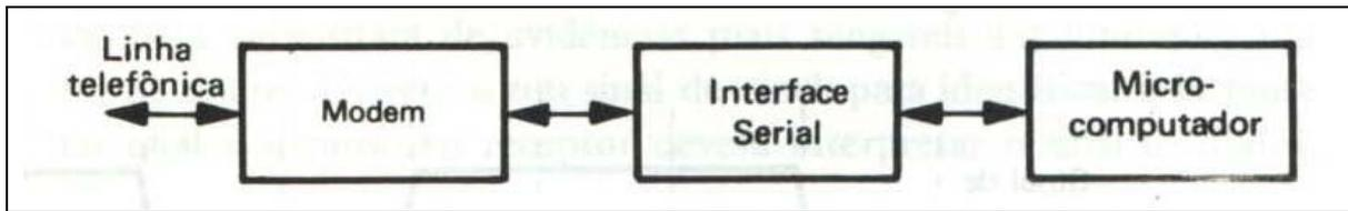
Um modem é um dispositivo que pode transformar sinais de linha telefônica em níveis lógicos digitais, ou níveis lógicos em sinais de linha telefônica.
