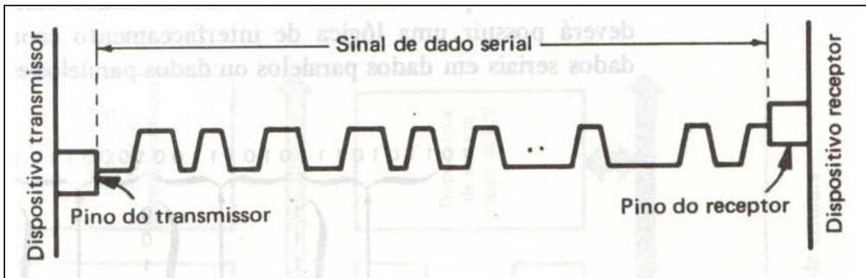
**Como um sinal serial pode ser interpretado pelo dispositivo receptor?** Como qualquer outro sinal digital, o sinal de dados terá um nível "alto" (cerca de +5V), ou um nível "baixo" (cerca de 0V).
