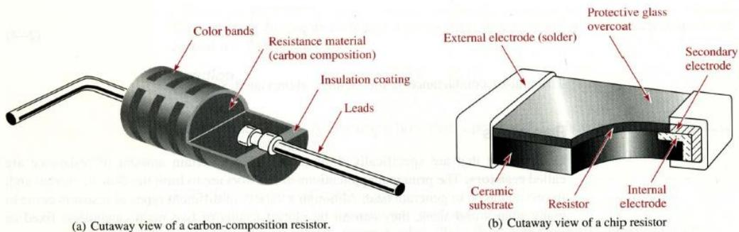
Fig.2: a) Resistor de composição de carbono e b) resistor tipo chip.
