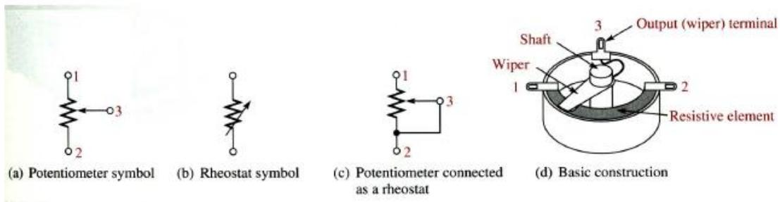
Fig. 5: Potenciômetro e reostato
