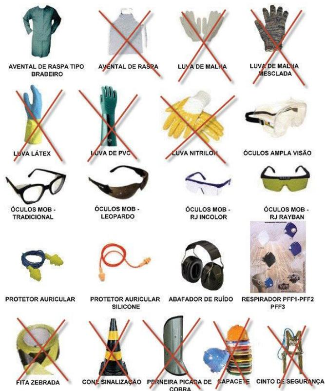
Figura 1.9.6: EPI's necessários para uso do torno.
