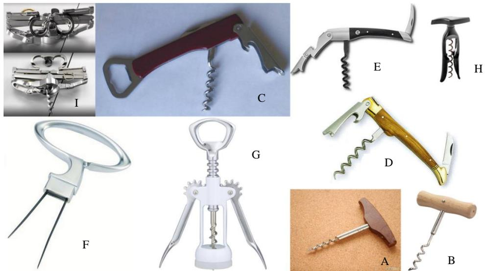
Figura 1.1.1: Diferentes modelos de saca-rolhas: A) saca-rolhas simples com mecha cheia; B) saca-rolhas simples com mecha em rabo de porco; C) limonadier; D) faca de sommelier; E) saca-rolhas com duas pontas; F) saca-rolhas de lâmina dupla; G) saca-rolhas com alavanca; H) saca-rolhas screwpull; I) saca-rolhas sveid.
