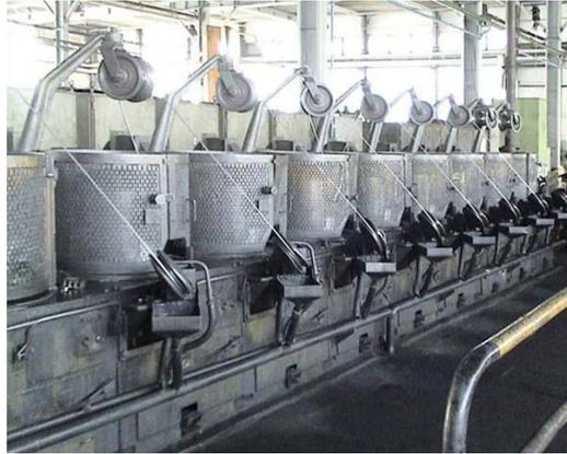
Figura 1.9.4: Máquina para trefilação.
