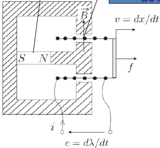
A **Lei de Faraday** afirma que o incremento da tensão  $de$  em um comprimento elementar  $dl$  na direção da corrente induzida pelo movimento da bobina é:
