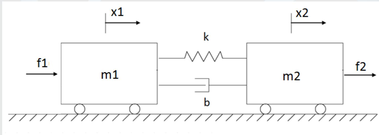
$$\begin{bmatrix} m_1 & 0 \\ 0 & m_2 \end{bmatrix} \begin{bmatrix} \ddot{x}_1 \\ \ddot{x}_2 \end{bmatrix} + \begin{bmatrix} b & -b \\ -b & b \end{bmatrix} \begin{bmatrix} \dot{x}_1 \\ \dot{x}_2 \end{bmatrix} + \begin{bmatrix} k & -k \\ -k & k \end{bmatrix} \begin{bmatrix} x_1 \\ x_2 \end{bmatrix} = \begin{bmatrix} f_1 \\ f_2 \end{bmatrix}$$
