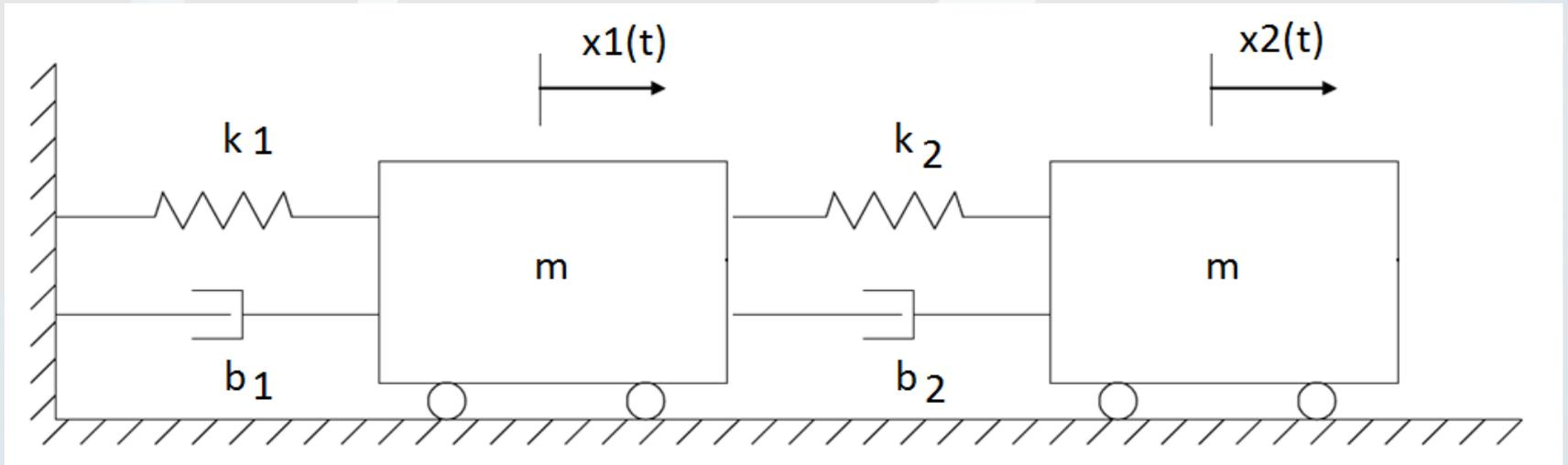
$$m_1 \ddot{x}_1 + b_1 \dot{x}_1 - b_2 (\dot{x}_2 - \dot{x}_1) + k_1 x_1 - k_2 (x_2 - x_1) = 0$$
