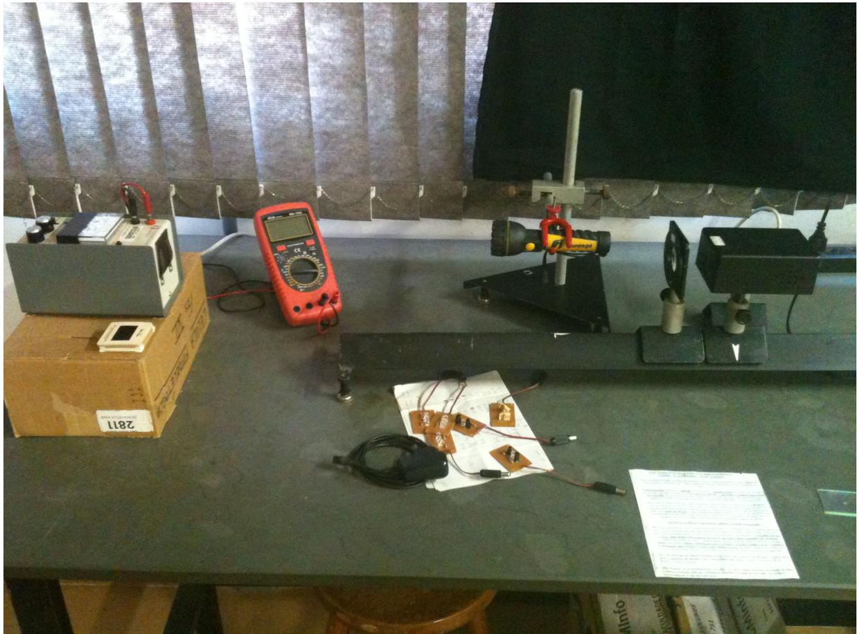
**Figura 4.1:** Montagem experimental para o efeito fotoelétrico. As fontes ao lado direito são o laser, LEDs, e uma fonte branca com filtros que podem ser posicionados na entrada do detector. Este detector absorve a radiação e gera uma corrente, a qual pode ser freada com um potencial retardador.
