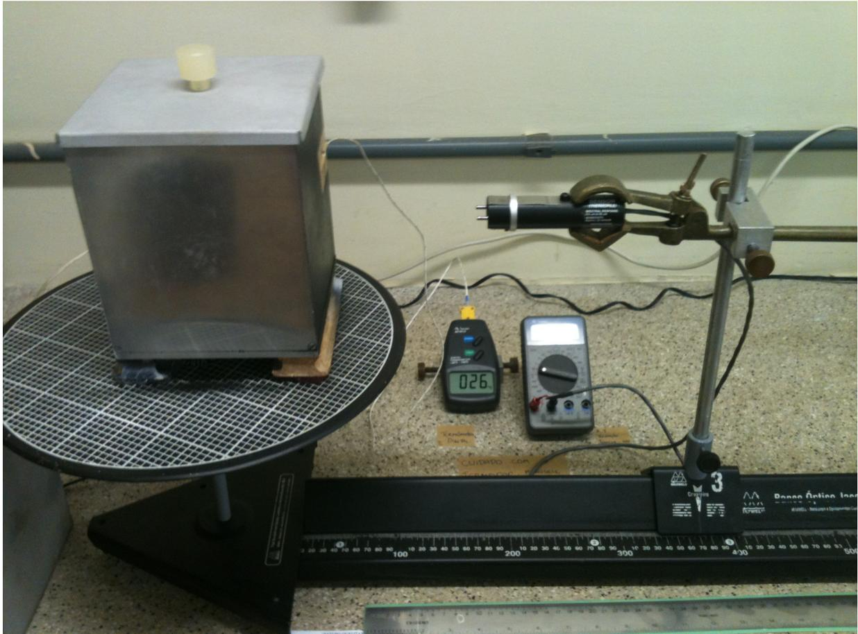
**Figura 1.2:** *Cubo de radiação térmica, com um termômetro digital acoplado a uma das faces e o detector de radiação posicionado em frente a face preta.*
