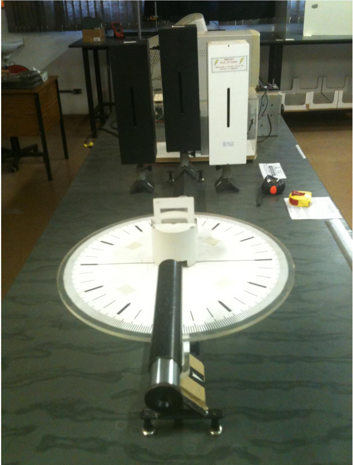
**Figura 2.1:** Fontes de plasma do experimento da série de Balmer posicionadas para observação pelo telescópio. A radiação da fenda de saída da fonte atravessa pela grade de difração, o ângulo de difração é mensurado pelo goniômetro posicionado na base do telescópio.
