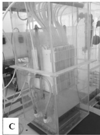
Figura 4. Sistema de membrana de placa plana, onde: A – placa de PVC usinada; B - membrana de placa plana e; C – cassete de membrana de placa plana.
