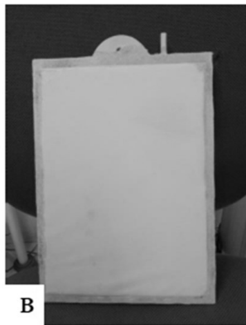
Figura 4. Sistema de membrana de placa plana, onde: A – placa de PVC usinada; B - membrana de placa plana e; C – cassete de membrana de placa plana.
