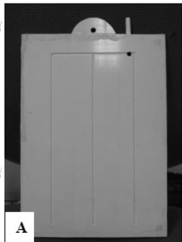
Figura 4. Sistema de membrana de placa plana, onde: A – placa de PVC usinada; B - membrana de placa plana e; C – cassete de membrana de placa plana.
