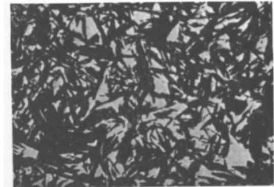
FIGURA 244 Templado y revenido a 200°.
