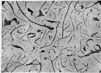
Fig. 534 — Ferro fundido cinzento, sem ataque, com veios do tipo A. 150x.
