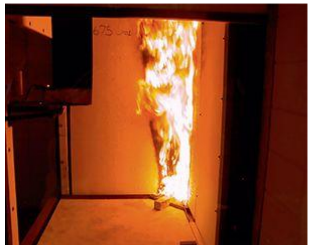
Figura 2 - Ensaio de reação ao fogo pelo método EN 13.823 (SBI)
