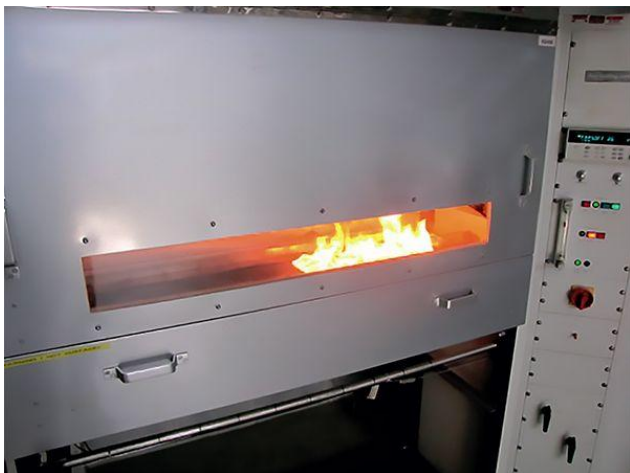
Figura 3 - Ensaio de fluxo crítico de energia radiante pela norma NBR 8.660:2013
