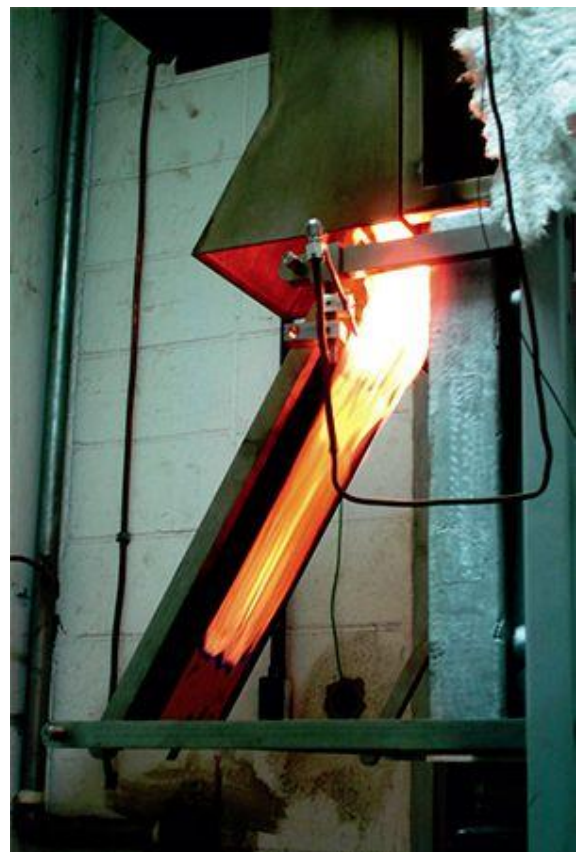
Figura 1 - Ensaio de propagação superficial de chama pela NBR 9.442:1988
