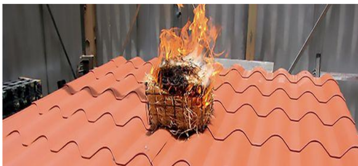
Figura 4 - Ensaio de cobertura pela norma ENV 1.187 (Test Methods for External Fire Exposure to Roofs)
