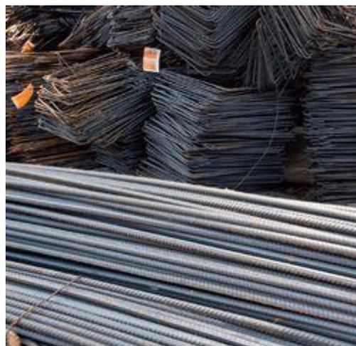
Ao dispensar as etapas e mão de obra necessárias ao corte e dobra do aço, a tecnologia do aço pronto permitiu à OR reduzir o tempo de preparação e montagem da armadura das lajes
