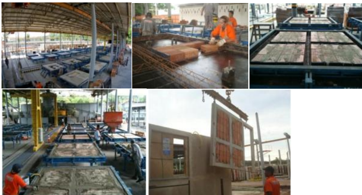
Figura 16 – Painéis pré-fabricados com nervuras de concreto e preenchimento de blocos cerâmicos (Fonte: Datec 012, disponível em http://www.cidades.gov.br/pbqg-h/projetos_sinat.php )
