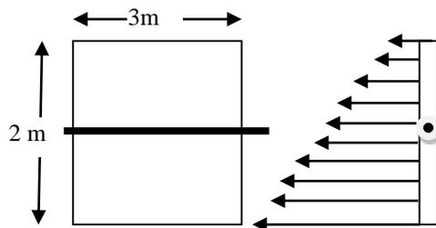
Usando o conceito de altura média onde a força resultante deve ser aplicada, vemos que por causa da pressão diferenciada da parte superior ou da parte inferior haverá um toque resultante.
