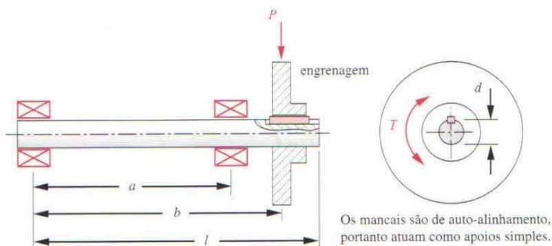
**Questão 2 (5,0 pontos)** - Um eixo suporte de um cilindro de colheitadeira foi submetido à análise de tensões para determinar que o diâmetro mínimo requerido com base na resistência é de 40 mm em uma das sedes propostas para o mancal. A partir da análise de forças associadas e de outras especificações de projeto, as seguintes informações são obtidas:
