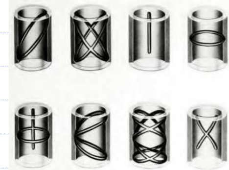
Tipos de sulcos para buchas de mancais de deslizamento (Bunting Bearings Corp. Holland, OH apud Mott 2013)
