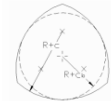
Desenho esquemático de um mancal trilobulado. Fonte: MACHADO, 2006, p.18.
