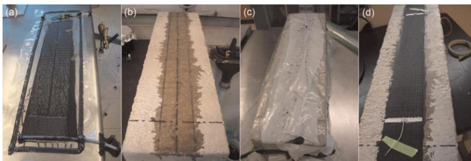
Figura 7. Preparação da superfície da viga com a aplicação de tela de fibra de vidro, tratada com a resina de epóxi/CNT [13].
