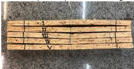
**Figura 10-** Corpos de prova Compensado longitudinal
