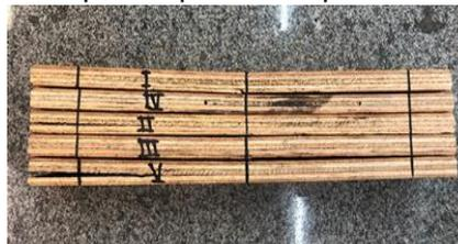
**Figura 11-** Corpos de prova OBS transversal
