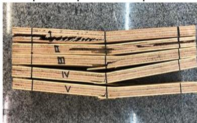
Quanto ao ensaio de tração observou-se que a forma de ruptura se dava sempre entre as camadas, neste caso a resistência das resinas colantes são também testadas (Figura I).
