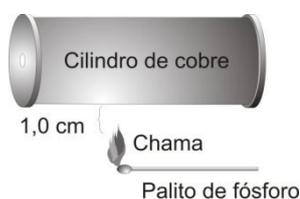
**Figura 1.** Esquema do aquecimento do cilindro de cobre pela chama do fósforo, que ilustra a distância entre a chama e o cilindro.
