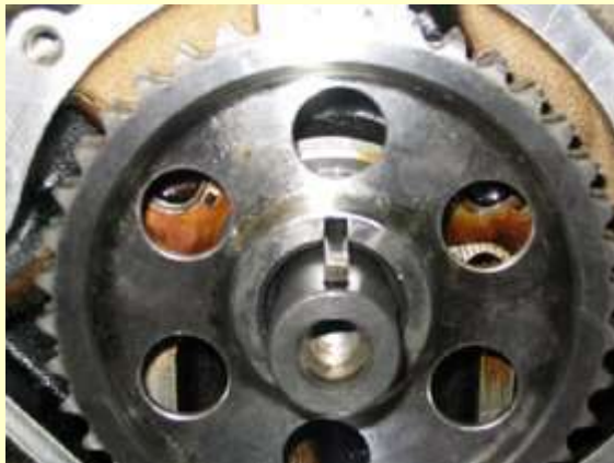
Detalhe da ranhura e de uma chaveta paralela utilizada para fixar a engrenagem ao eixo
