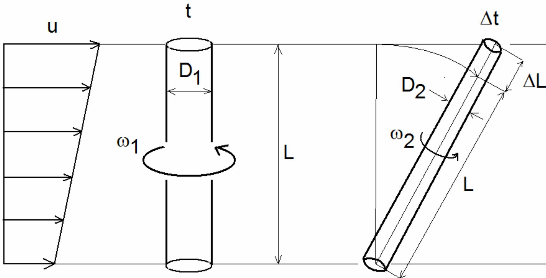
Na figura, temos um trecho de um vórtice sendo estirado pelo gradiente de velocidade, entre os instantes  $t$  e  $t + \Delta t$ .
