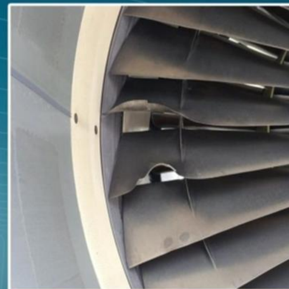
Turbina de avião após choque com ave (Foto: Reprodução/TV Globo)
