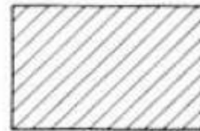
tijolo, alvenaria de pedra
