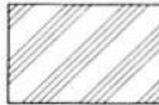
borracha, plástico e isolamento elétrico
