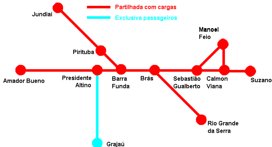
FIGURA 2.2.2-2 COMPARTILHAMENTO DE LINHAS FERROVIÁRIAS NA RMSP
