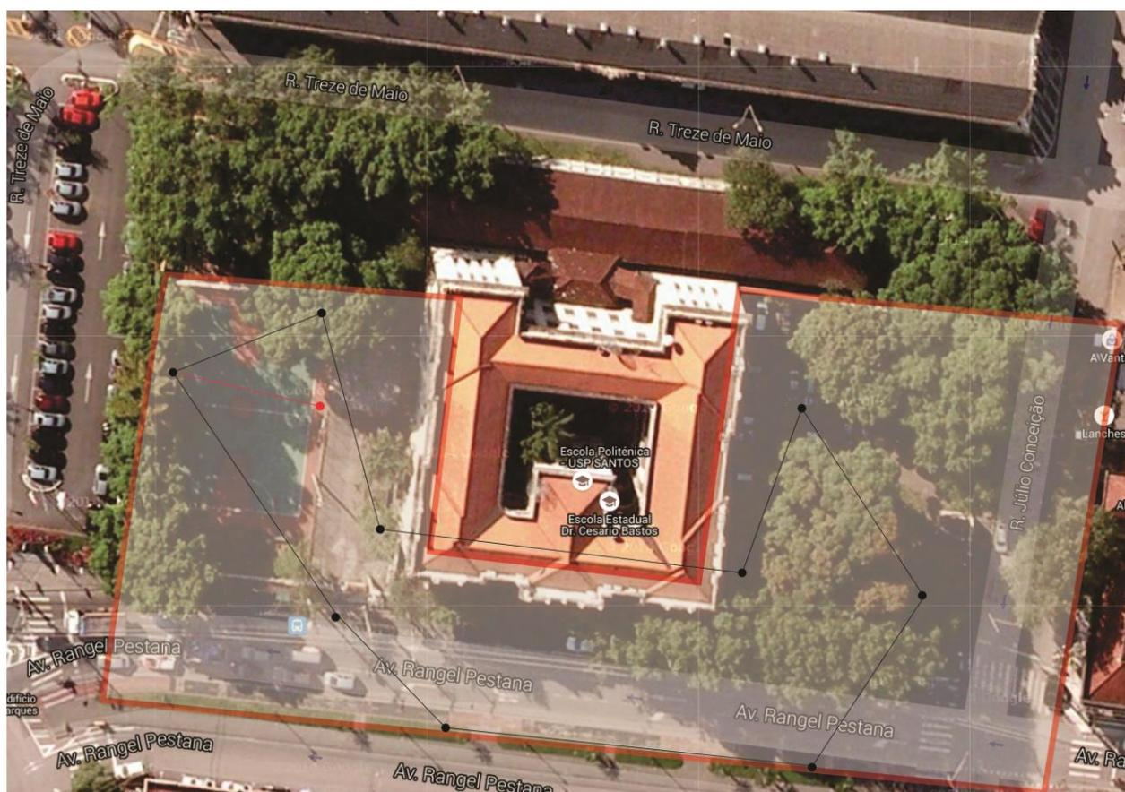
*Figura 1- Área de abrangência para o levantamento do Projeto Final 2019, com exemplo de poligonal com respectivos vértices.*
