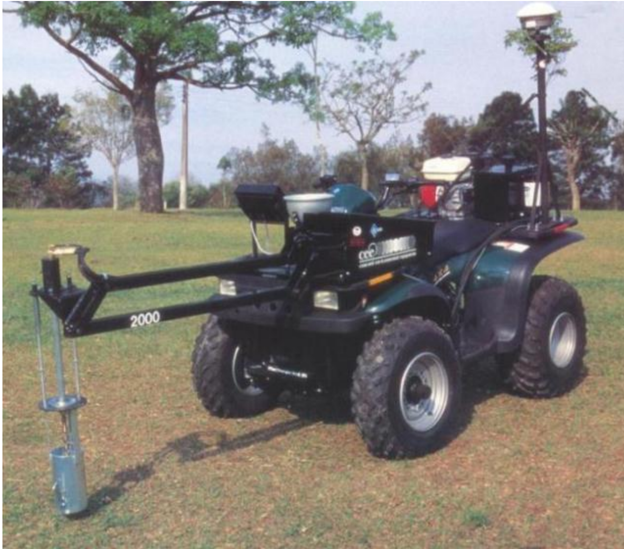
Amostrador tipo rosca, de acionamento por motor hidráulico, sobre um quadriciclo
