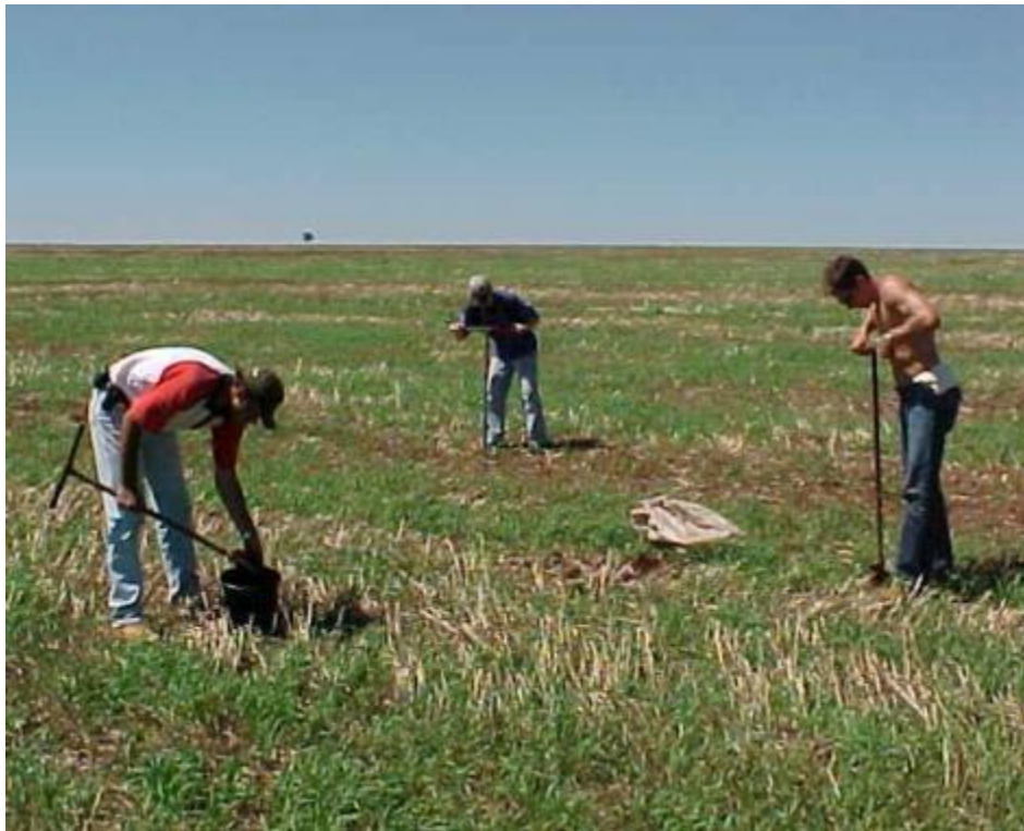
Amostragem de solo com trado holandês, operado manualmente
