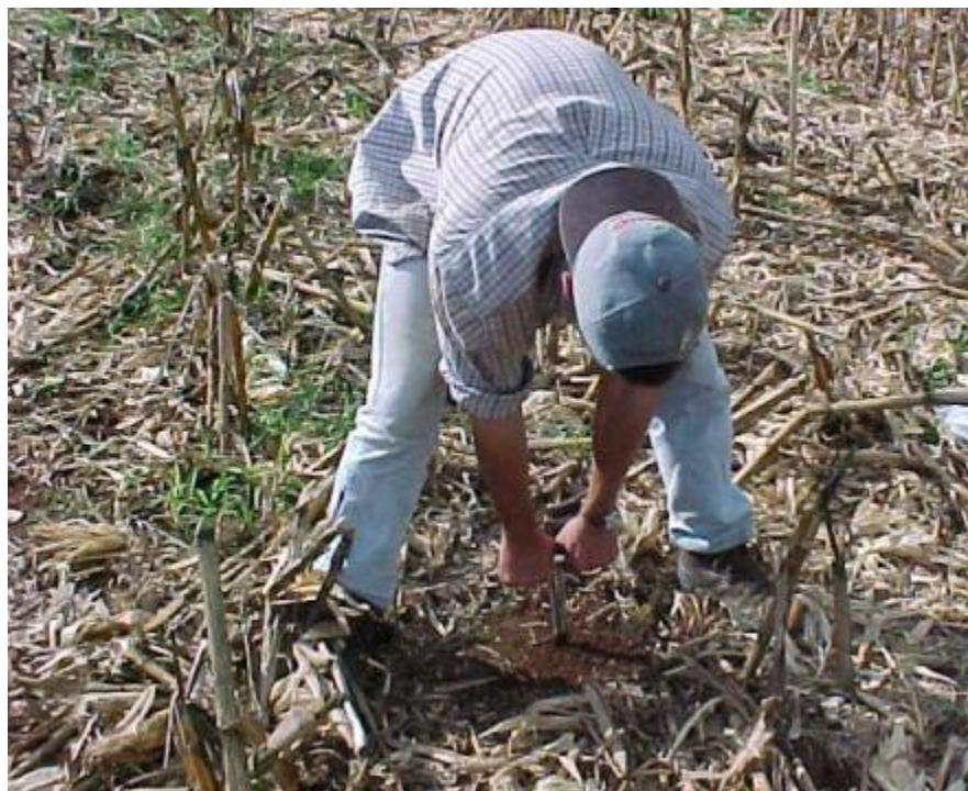
Amostragem de solo com trado calador, operado manualmente
