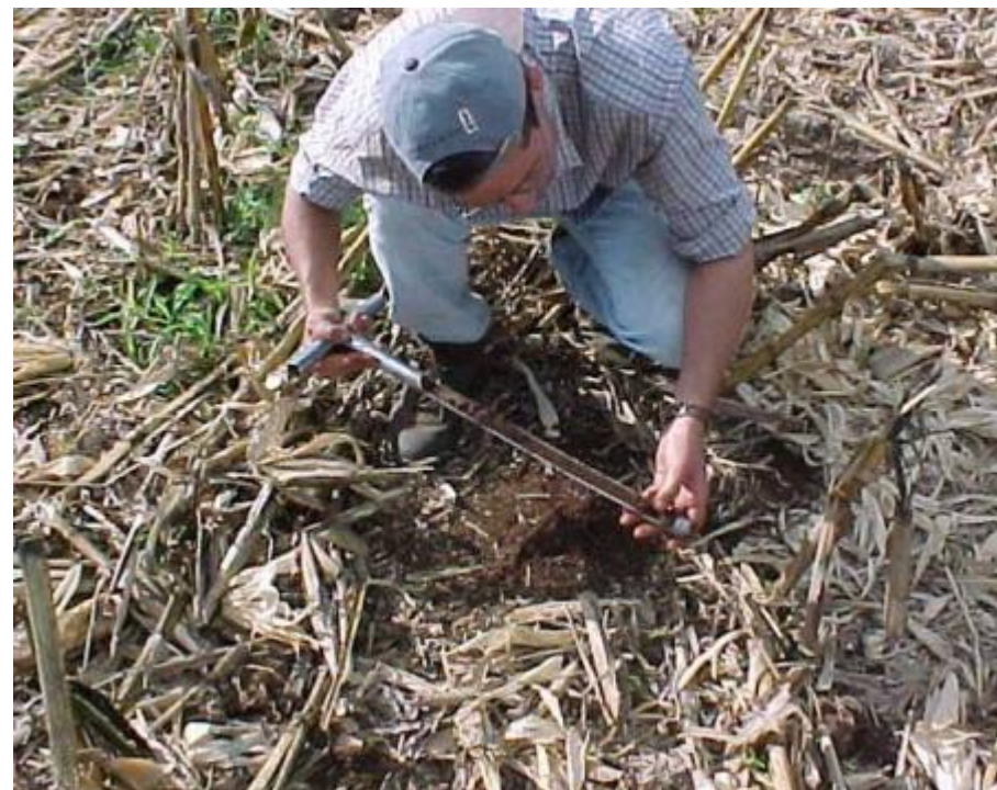
Amostragem de solo com trado calador, operado manualmente
