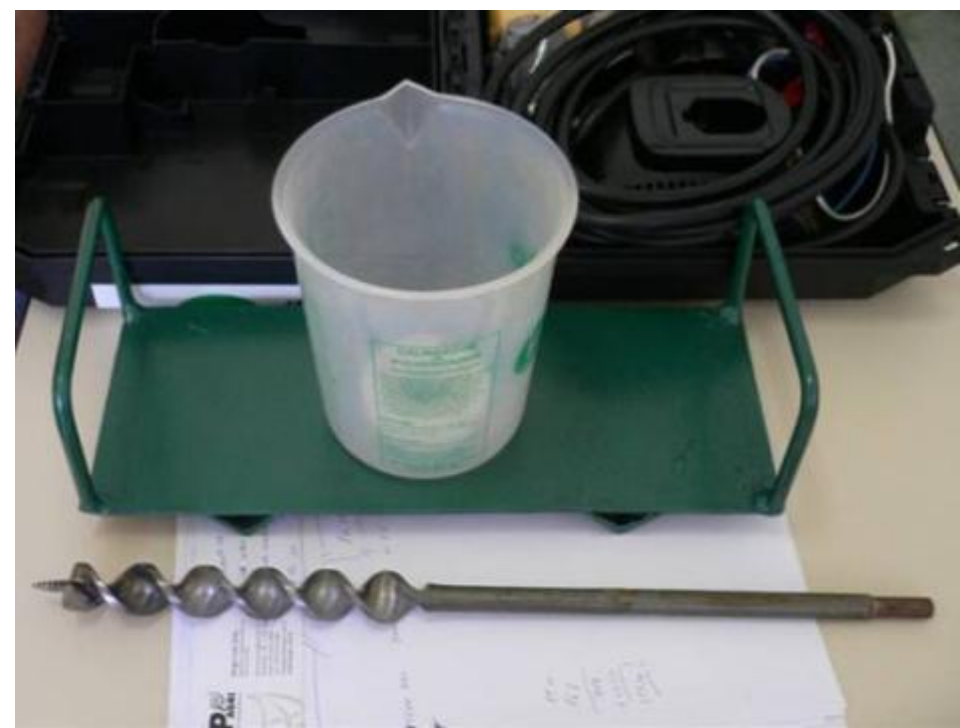
Amostragem de solo com trado de rosca, operado manualmente
