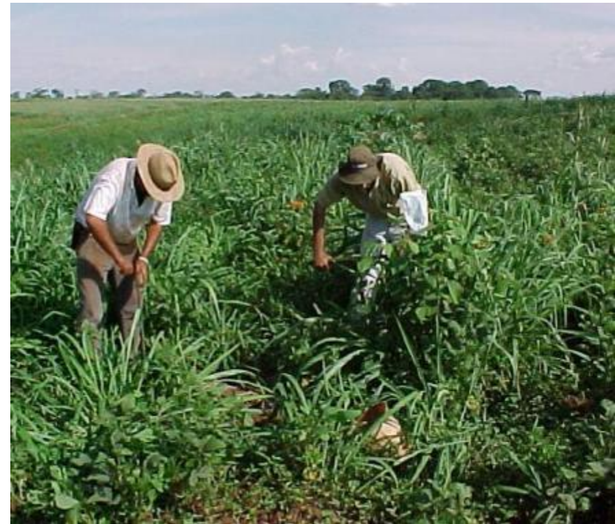
Amostragem de solo com trado holandês, operado manualmente
