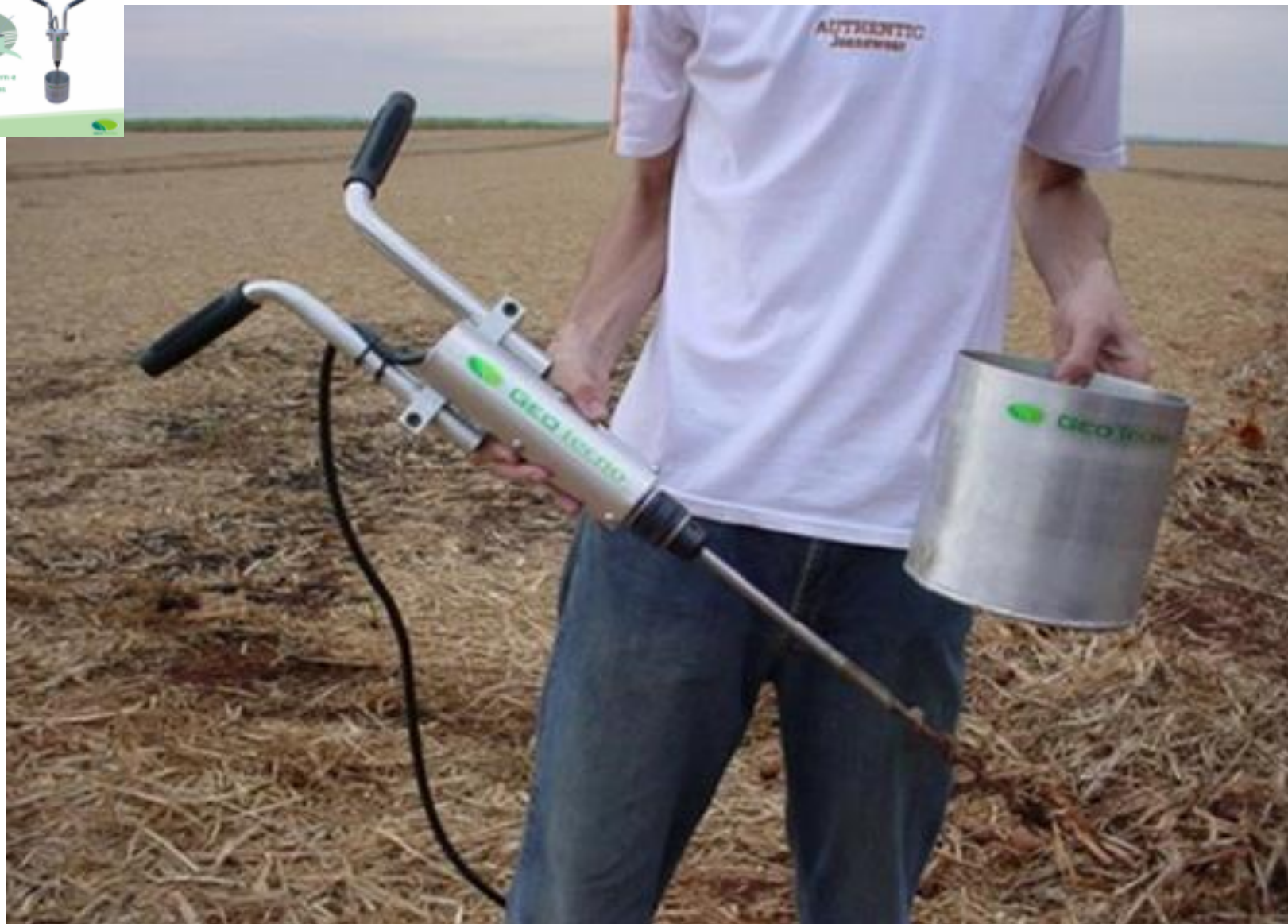
Amostrador tipo rosca, de acionamento por motor elétrico, operado manualmente
