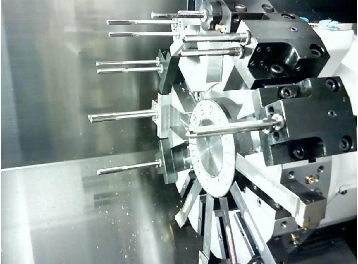
Figura 1.7 – Exemplo de carro porta-ferramentas de um torno CNC.
