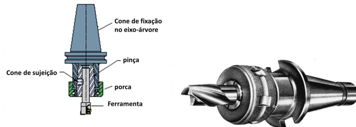
Figura 2.9 – Exemplo de fixação da fresa por meio de pinça.
