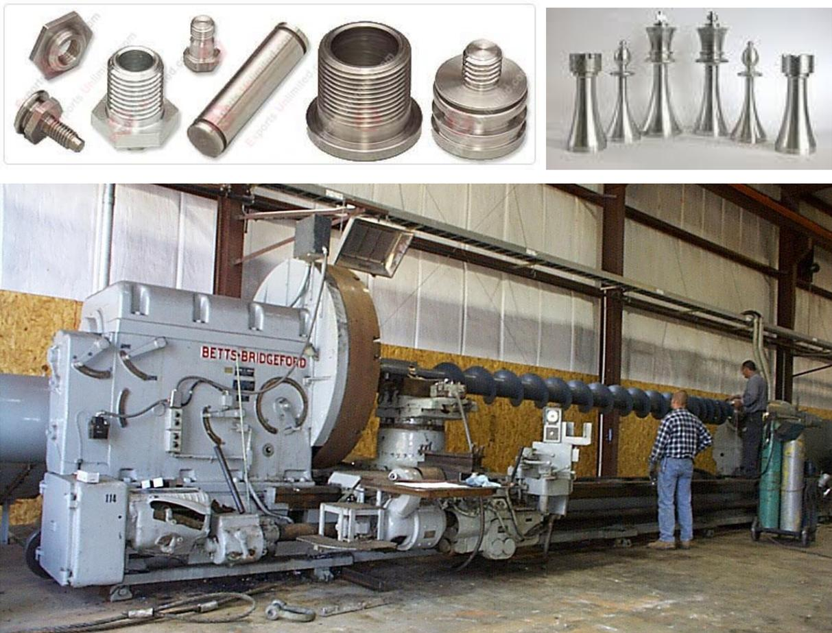
Figura 1.1 – Exemplo de peças fabricadas por torneamento.
