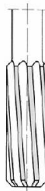
Canais helicoidais à esquerda ( \approx 10^\circ )
