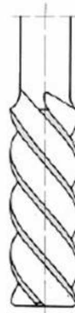
Canais helicoidais à esquerda para desbaste ( \approx 45^\circ )
