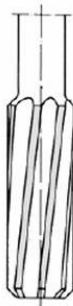
Canais helicoidais à direita ( \approx 10^\circ )
