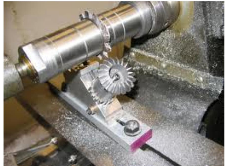
Fixação para corte de engrenagens dentes cônicos
