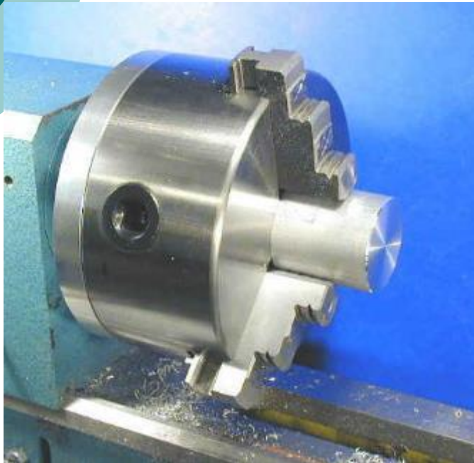
Fixação por placa de 3 castanhas
