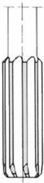
Canais retos com entrada helicoidal à esquerda
