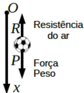
O movimento da bola é descrito pela função  $x(t)$  e a primeira e a segunda derivada dessa função representam a velocidade e a aceleração da bola, respectivamente. Para determinar o movimento da bola, utiliza-se a 2ª lei de Newton:
