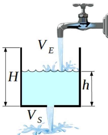
A água entra no reservatório com uma vazão  $V_E$  e sai pelo furo com uma vazão  $V_S$ . Nessas condições, a altura da água dentro de reservatório  $h(t)$  é a solução da equação diferencial de 1ª ordem:
