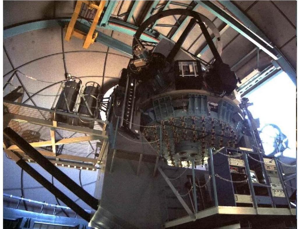
**Duas visões do SOAR. Pode-se ver na esquerda a montagem altazimutal e na direita os pistões hidráulicos da óptica ativa.**
