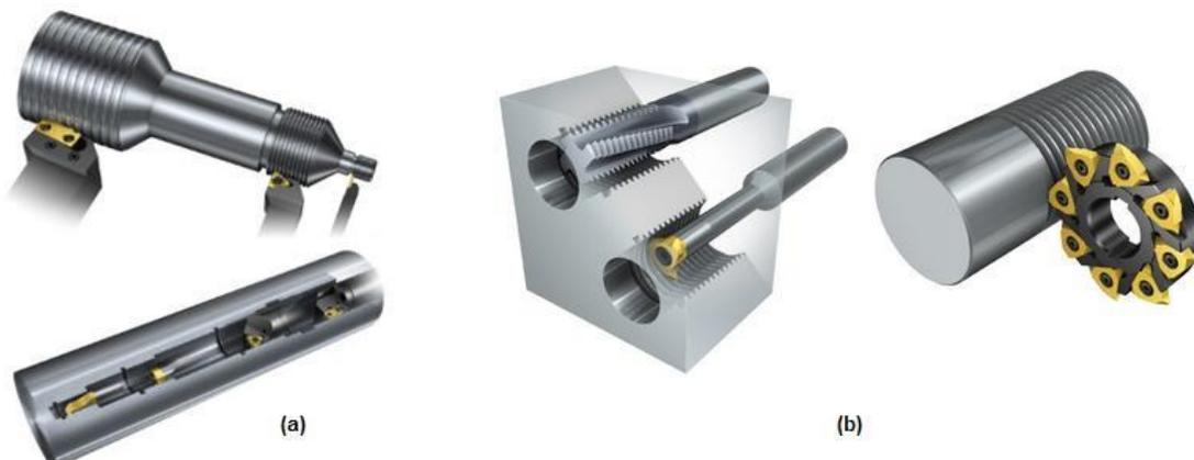
**Figura 1.4** - (a) Usinagem com ferramenta monocortante; (b) usinagem com ferramenta de corte intermitente
