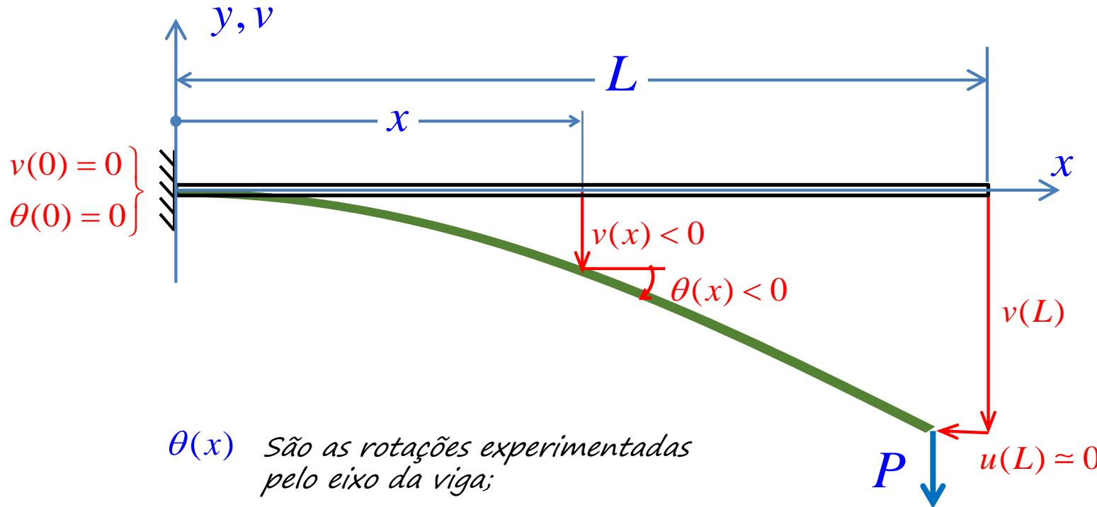
$\theta(x)$  São as rotações experimentadas pelo eixo da viga;
