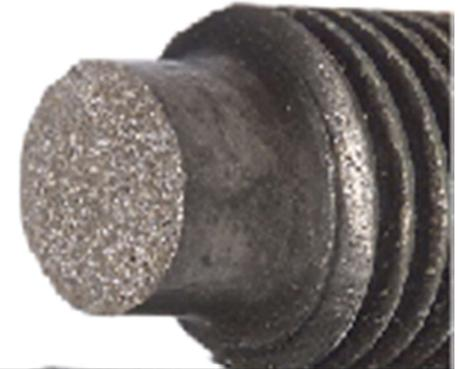
Fratura frágil ocorre sem qualquer deformação apreciável e através de uma rápida propagação de trincas
