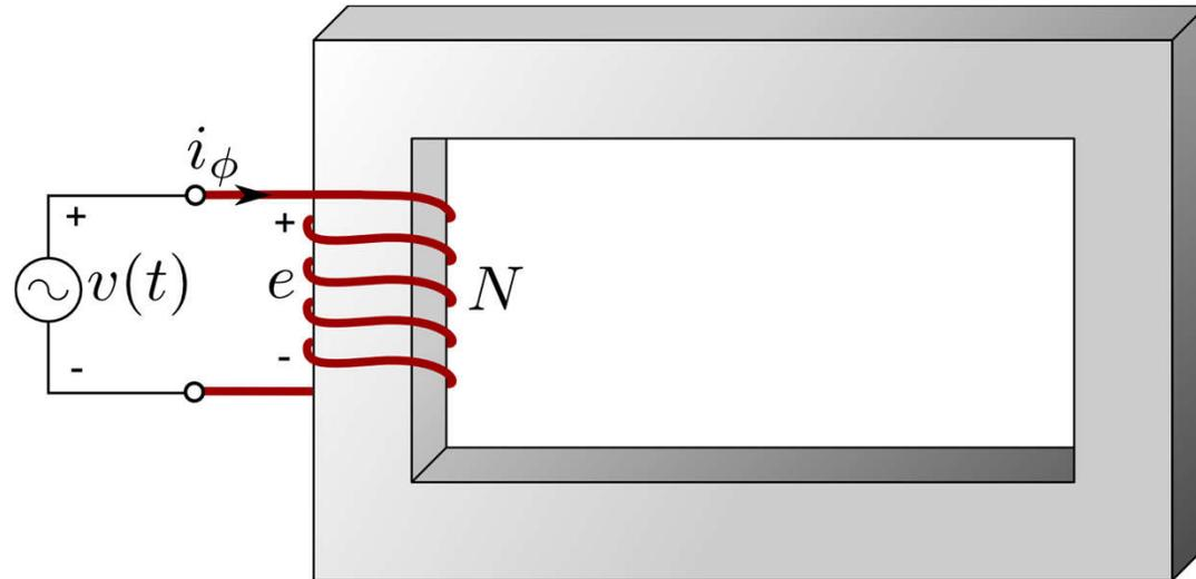
Admitindo fluxo magnético senoidal  $\rightarrow \phi = \phi_{max} \text{sen}(\omega t)$
