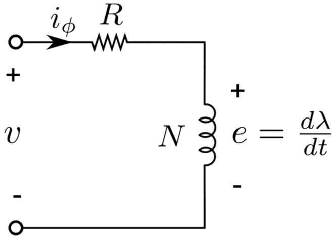
Nesse caso a tensão aplicada e a tensão induzida nos terminais das bobinas são diferentes
