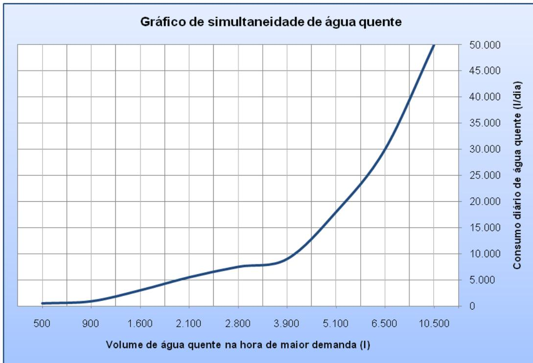
**Figura 25** – Fator de simultaneidade do consumo de água quente
