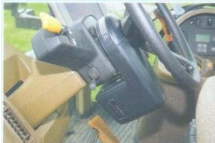
Motor elétrico com corrente na coluna de direção
