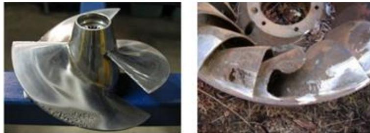
Figura 20: Exemplos de rotores danificados pelo processo de cavitação.
