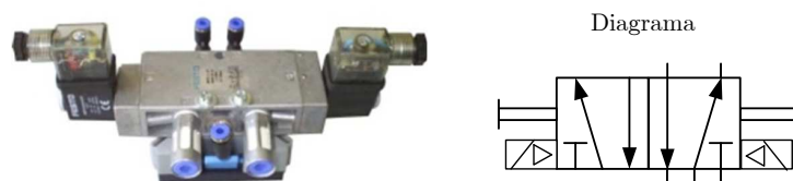
Figura 2.7: Eletroválvula direcional de 5/2 vias com duplo acionamento e memória.
