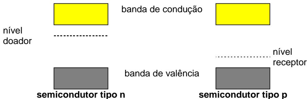
A combinação de semicondutores *p* com semicondutores *n* é a base da microeletrônica. O exemplo mais simples é um diodo formado pela junção de um *p* com um *n*. A corrente elétrica no componente *p* corresponde a um fluxo de vazios positivos. No componente *n*, ela corresponde a um fluxo de elétrons. Apliquemos tensão ao dispositivo abaixo, que tem um componente *p* à direita e um *n* à esquerda:
