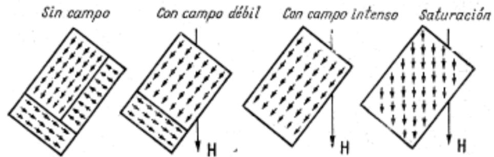
Fig. 2.3 - Esquema de orientação dos spins nos domínios.
