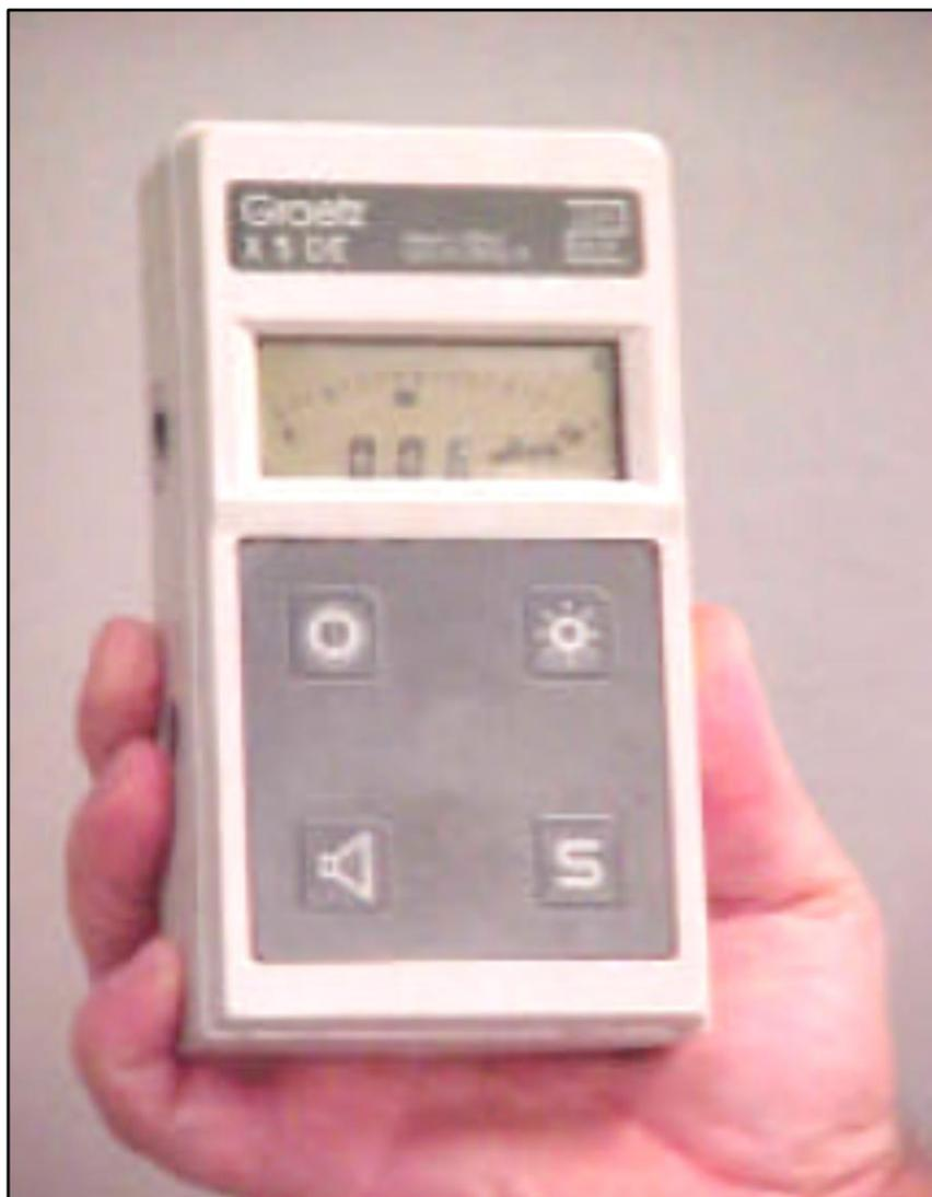
Detetor Geiger Muller digital, atua numa faixa de energia de 40 keV até 3 MeV com precisão de  $\pm 20\%$ , possui escalas automáticas de 1  $\mu\text{Sv/h}$  até 9,99 mSv/h , com peso de 500 gramas
