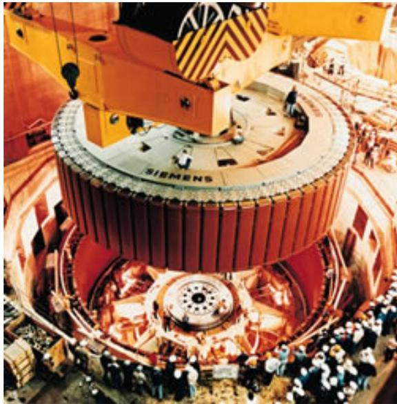
*Rotor e estator de unidade geradora de Itaipu
