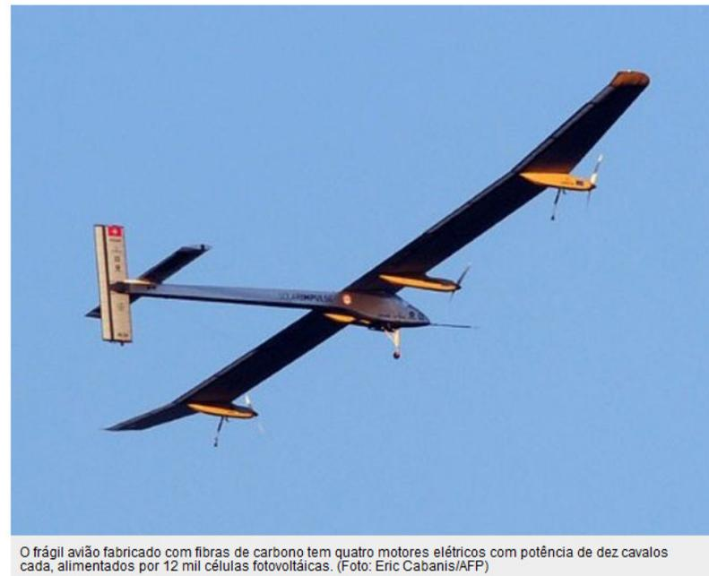
O frágil avião fabricado com fibras de carbono tem quatro motores elétricos com potência de dez cavalos cada, alimentados por 12 mil células fotovoltaicas. (Foto: Eric Cabanis/AFP)
