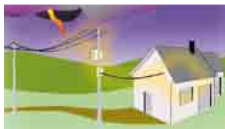
Impacto direto de um raio na linha aérea de baixa tensão
